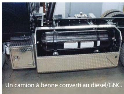
Un camion à benne converti au diesel/GNC.
